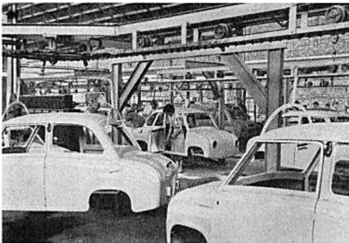
Karosserien noch langem Fertigungsweg bereit zum Aufsetzen auf die Chassis
