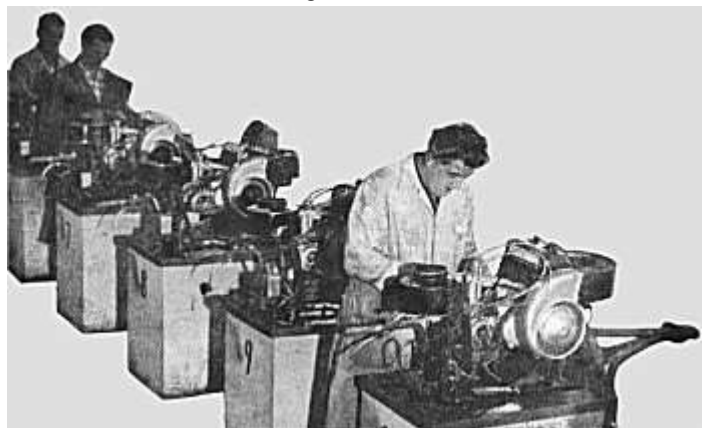
Probelauf der Motore auf den Prüfständen
